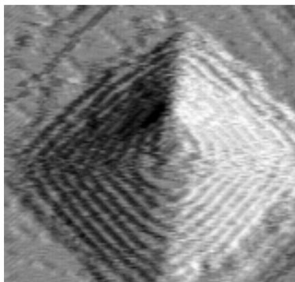
図1 . Si(001)表面上に現れた Si のナノピラミッド . 上方から見ている . (Ichimiya 等による)
